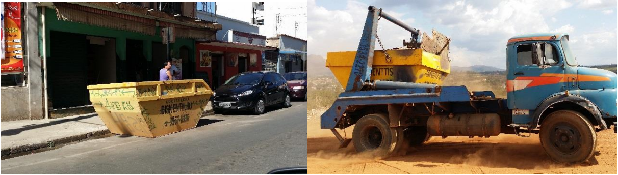
Figura 85 – Caçambas e caminhão utilizados para coleta dos RCC
